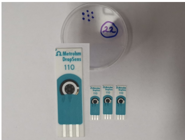
Figura 9. SPCE modificati cu formularea printabila pe baza de GO – model 2 (P2).
