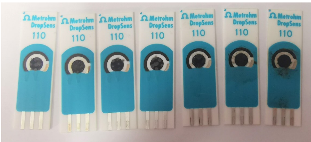
Figura 7. SPCE pe care au fost testati parametri de modificare cu formularea printabila pe baza de GO pentru fiecare model in parte.
