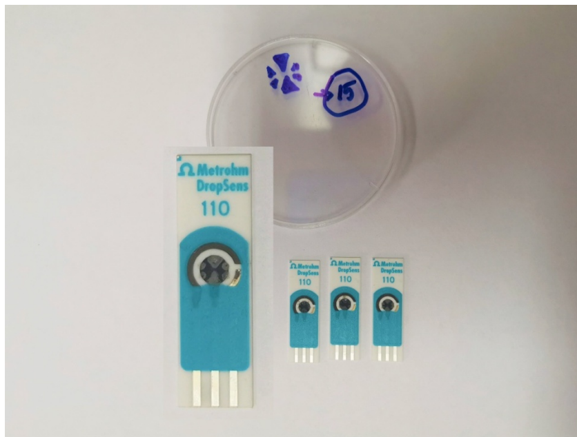
Figura 8. SPCE modificati cu formularea printabila pe baza de GO – model 1 (P1).
