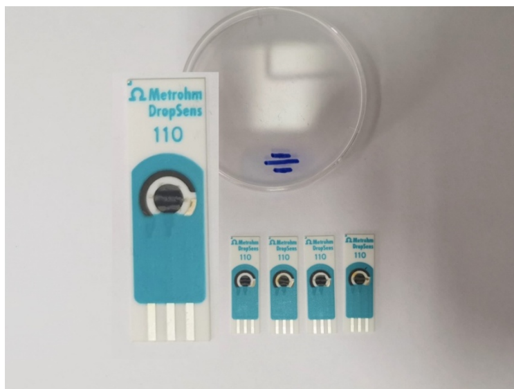
Figura 10. SPCE modificati cu formularea printabila pe baza de GO – model 3 (P3).
