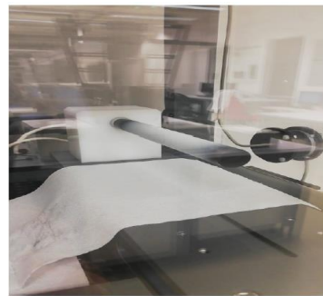
Figura 6. Procesul de electrofilare și membrana pe bază de nanofibre polietilenoxid și chitosan.
